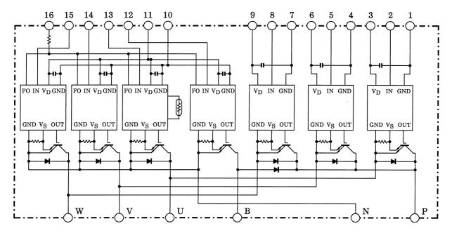
1. GND (U) 2. IN (U) 3.  $V_D(U)$ 4. GND (V) 5. IN (V) 6.  $V_D(V)$ 9. V<sub>D</sub> (W) 15.IN (Z) 10.GND (L) 7. GND (W) 8. IN (W) 11.V<sub>D</sub> (L) 12.IN (B)
