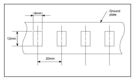
Fig.3.5.5(d) Ground plate holes
