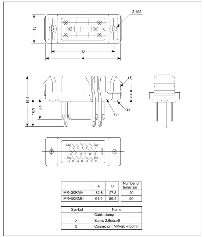
Fig.C4 (d) HONDA connector (female)
